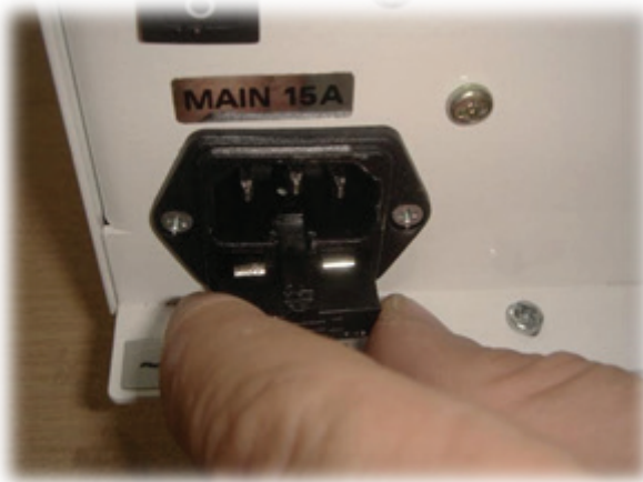
تصویر ۸- نحوه تعویض فیوز وکیوم میکسر
